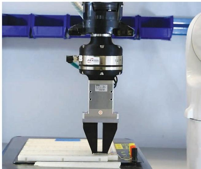
ATIの力/トルクセンサーを使用した高精度電子アセンブリ
