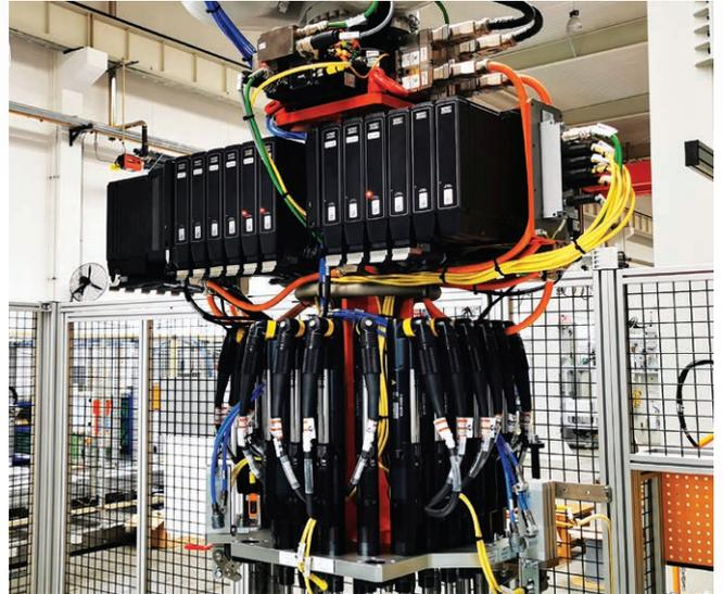
ATI QC-210高荷重用ツールチェンジャーを使用した複雑なナットランナーシステム
