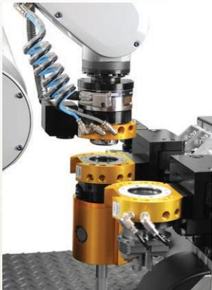
マスタープレートはロボットアームに取り付けられ、空気圧駆動のロック機構によってツールプレートに固定されます。このロック機構には、当社の特許取得済みのマルチテーパーカム設計およびフェールセーフボールロックテクノロジーが採用されています。
