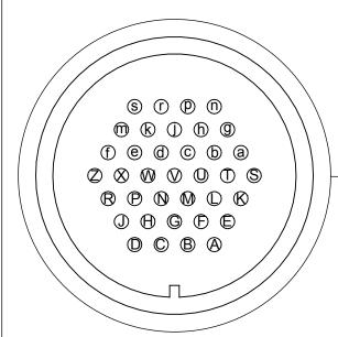
37-Pin Male Connector (Master) DDK DMS 3102 A28-21P Face View Scale 3:2
